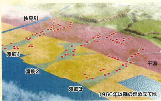
2011年東北地方太平洋沖地震に伴う千葉県稲毛海岸周辺の液化化マップ。この地域は干潟や埋め立て地が広がっているが、液化化(赤丸)は滞筋に沿って多発した。(下河・稲垣(2013)のデータをもとに編集部で作成)
